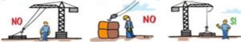
**ESTÁ PROHIBIDO** utilizar los elementos de elevación para arrancar cargas adheridas al suelo o paredes, así como cualquier otra operación extraña a las propias de manutención de cargas.
